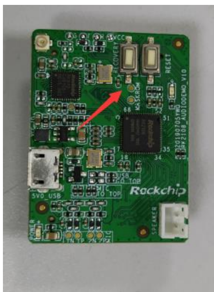
图4-4 SPI_FLASH与MASKROM测试点
